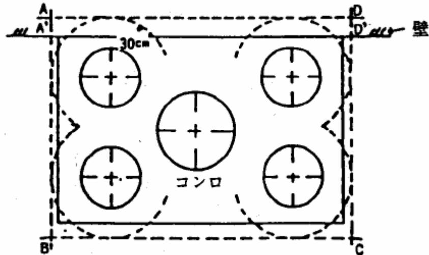
※ レンジが不燃材料等の壁に接して設置されている場合の被防護面積はA'・B・C・D'点を結んで得られる長方形の面積とする。
