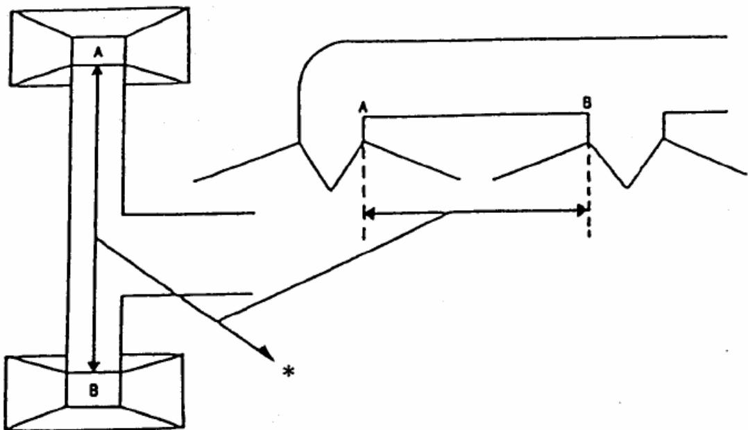
※ A、B間の距離が5m未満の場合、A、B双方のフード等用簡易自動消火装置を相互に連動させる。
