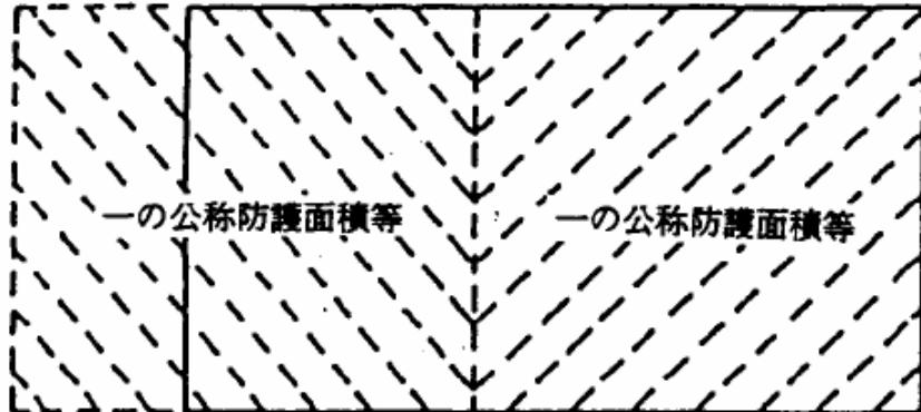
※ 同一型式の複数の消火装置を被防護面積等が警戒できるように設け、相互に連動させる。
