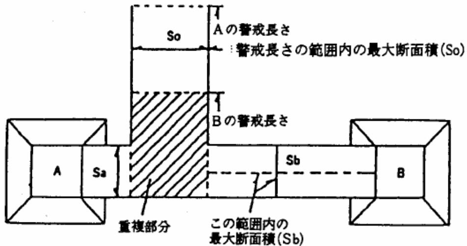
※ Aに設置するフード・ダクト用又はダクト用は、ダクトの公称防護断面積が  $S_o$  以上のものでなければならないが、Bに設置するフード・ダクト用又はダクト用は、ダクトの公称防護断面積が  $S_b$  以上のものとすることができます。
