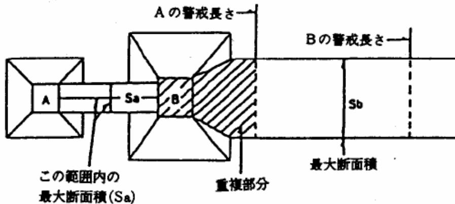
※ Bに設置するフード・ダクト用又はダクト用は、ダクトの公称防護断面積が  $S_b$  以上のものでなければならないが、Aに設置するフード・ダクト用又はダクト用は、ダクトの公称防護断面積が  $S_a$  以上のものとすることができます。
